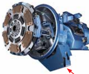
El actuador electrónico del embrague (ECA) en UltraShift PLUS "cambia activamente" según la carga, la pendiente y el pedal del acelerador. Los cambios completos son suaves y rápidos.
